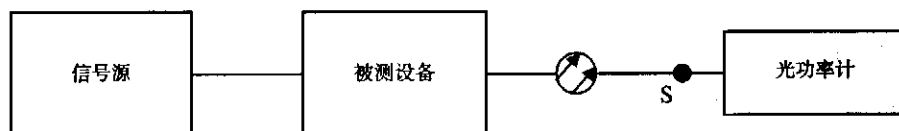
图2 平均发送光功率测试配置
